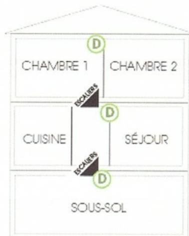
Si le logement possède plusieurs niveaux, il est recommandé d'installer un détecteur par niveau.
